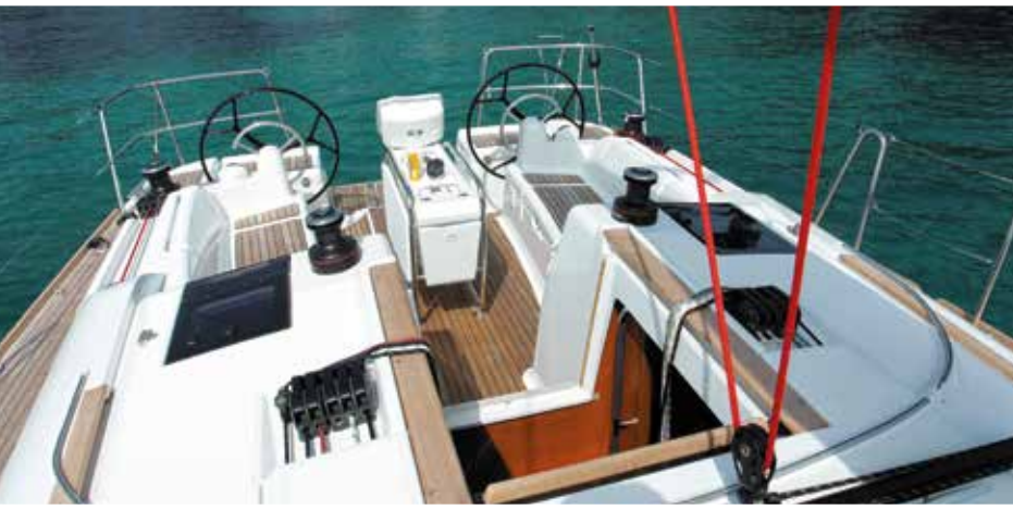
All sheets lead aft to the helm Centralisation des manœuvres à la barre Zentralisierung der Manöver am Ruder Centralización de las maniobras en el timón Manovre centralizzate al timone
